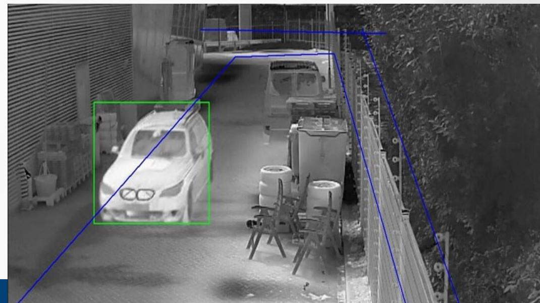
**DETECTOR NEURONAL TRASSIR** permite detectar la intrusión en un área protegida por un extraño, un automóvil o una bicicleta con los filtros avanzados para evitar falsos positivos.
