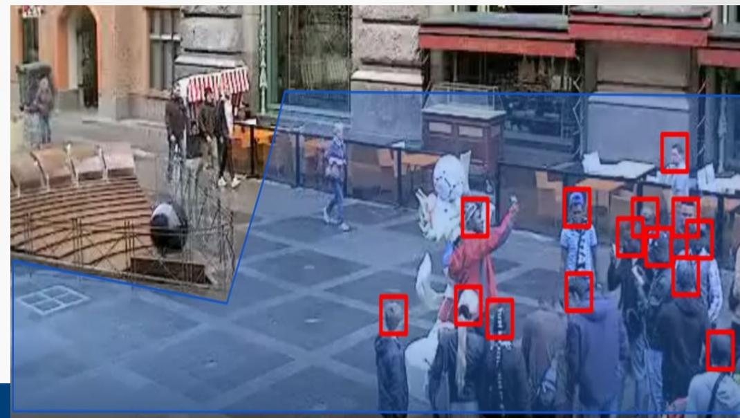
**TRASSIR DETECTOR DE MULTITUD** es un detector inteligente de hacinamiento excesivo de personas con un umbral de activación configurable basado en redes neuronales.
