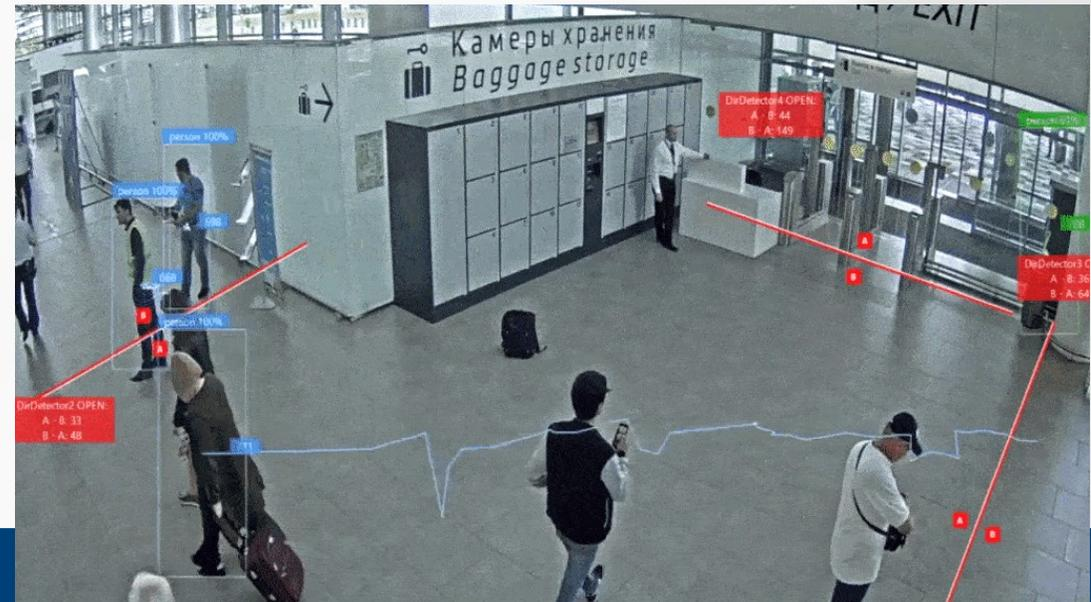
**DETECTOR DE DIRECCIÓN TRASSIR** permite detectar cualquier movimiento de una persona o bicicleta hacia la dirección prohibida.
