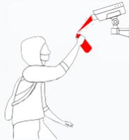
Détecter les instances de changement dans l'image transmise par la caméra
